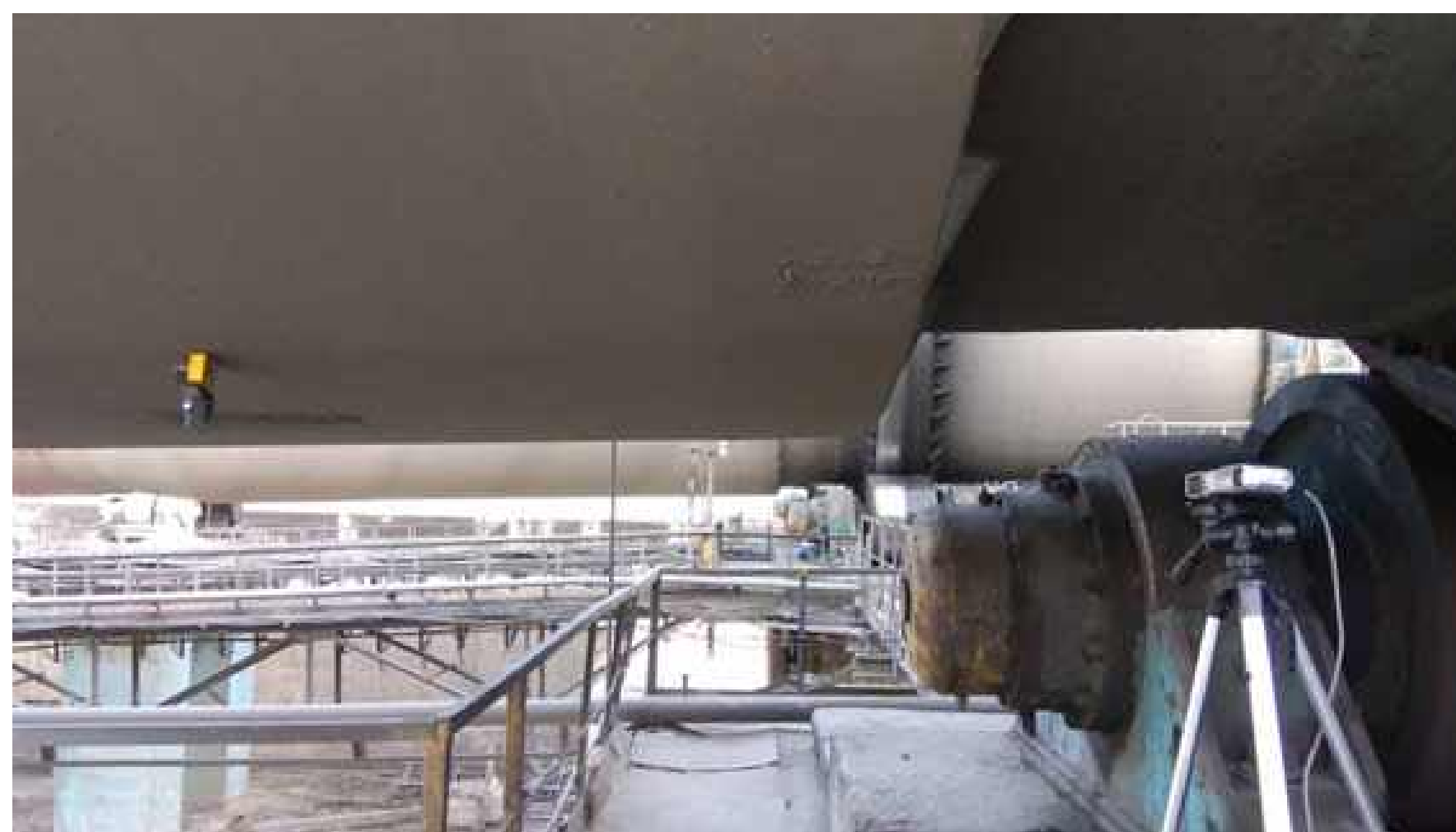
Датчик оборотов и система координат печи
