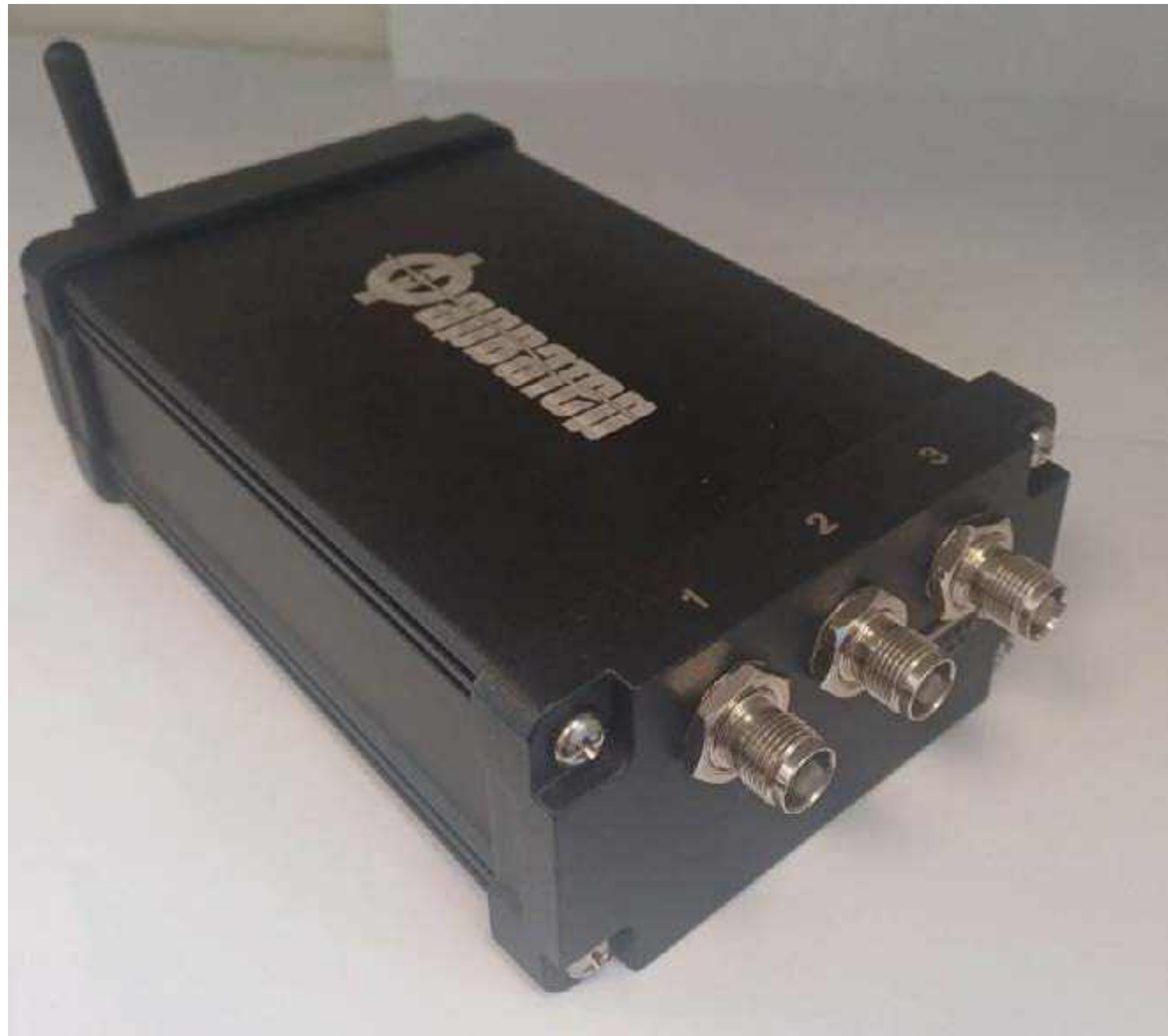
Спутниковый компас со встроенной технологией PPP «Фарватер-K3M-3X»
