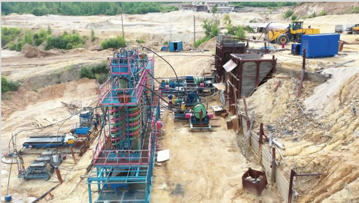
Гравитационная установка переработки вольфрамсодержащих хвостов обогащительной фабрики Бом-Горхон
