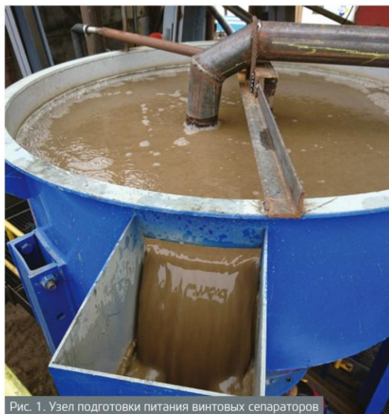
Рис. 1. Узел подготовки питания винтовых сепараторов
