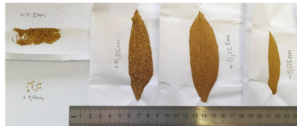
Рис. 4. Монофракции шлихового золота пробы № 1 по классам крупности. Суммарная масса – 130,17 г
