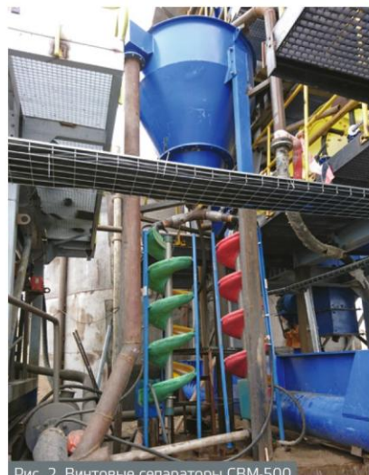
Рис. 2. Винтовые сепараторы CBM-500 и СВШ-500 в архитектуре ГОУ
