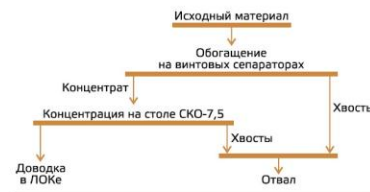
Рис. 1. Технологическая схема опытной установки винтовой сепарации
