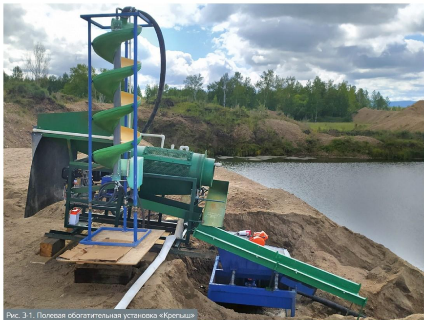
Рис. 3-1. Полевая обогатительная установка «Крепыш»
