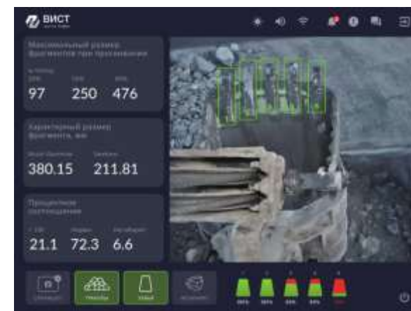
Контроль состояния зубьев – наличие и износ
